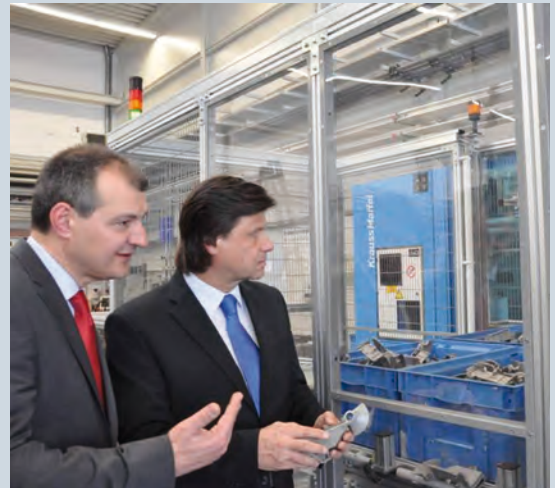
Der Roboter legt die geprüften Gutteile in die Container, die Schlechteile werden aussortiert. Rechts im Bild Martin Witulski, Geschäftsführer der SuK Kunststofftechnik und Reinhold Ziewers, Geschäftsführer der ASS Maschinenbau (li).
