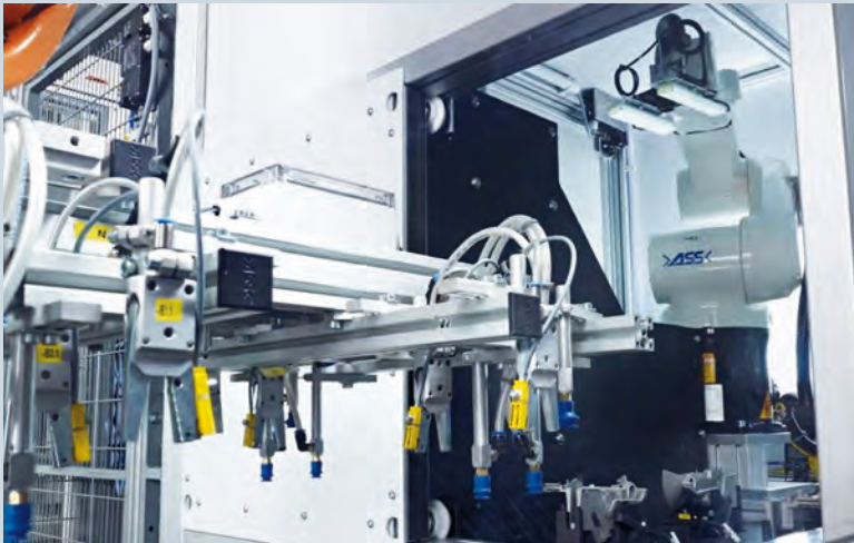
Blick in die Prüfkammer: Die GigE-Kamera ist ganz oben auf dem weißen Schwenkarm montiert, in der Mitte zwischen der Beleuchtung. Durch den Schwenkarm werden die beiden Prüfplätze abwechselnd bedient.
